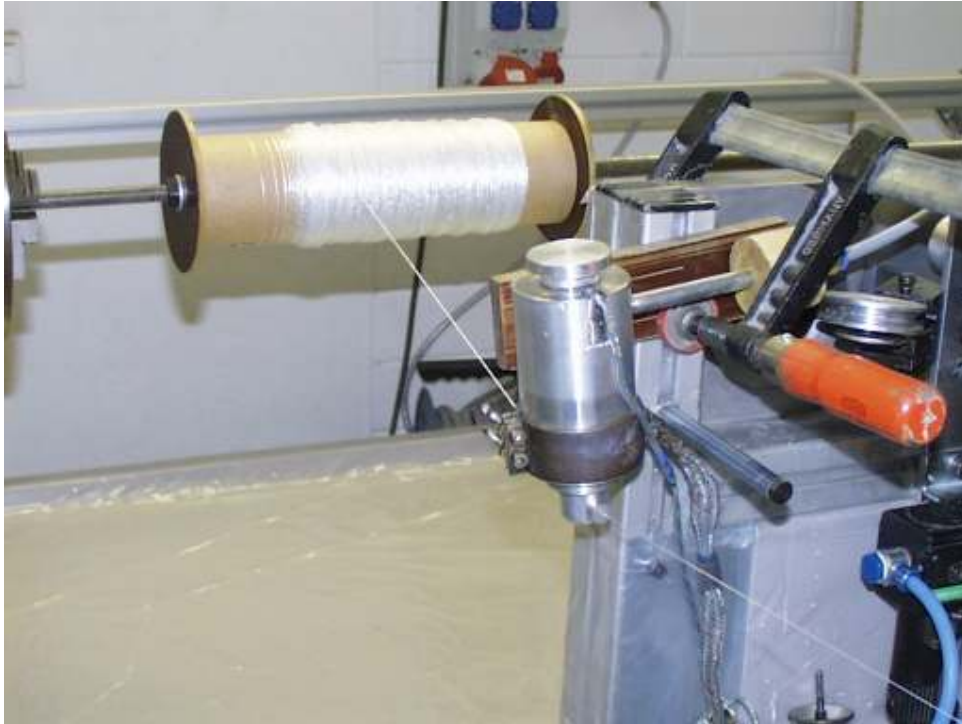
Abbildung 20: Herstellung eines ummantelten Trägerfadens
