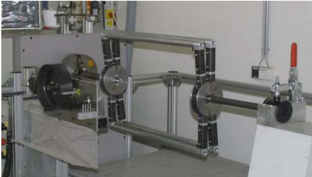
Abbildung 9: Gabelablage; eingeschwenkt zur Umfangsreduzierung
