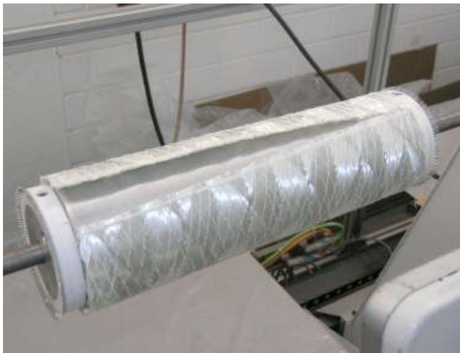
Abbildung 26: Entformung des Wickelgeleges
