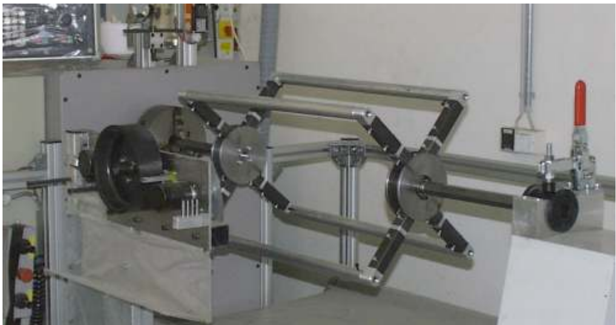
Abbildung 10: Gabelablage; ausgeschwenkt zur Umfangserhöhung
