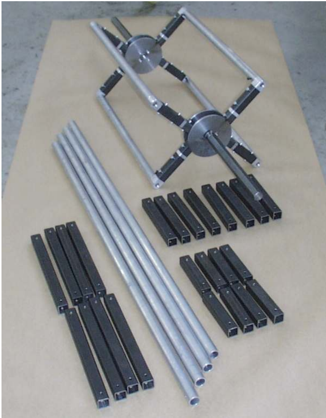
Abbildung 8: modular aufgebaute Gabelablage
