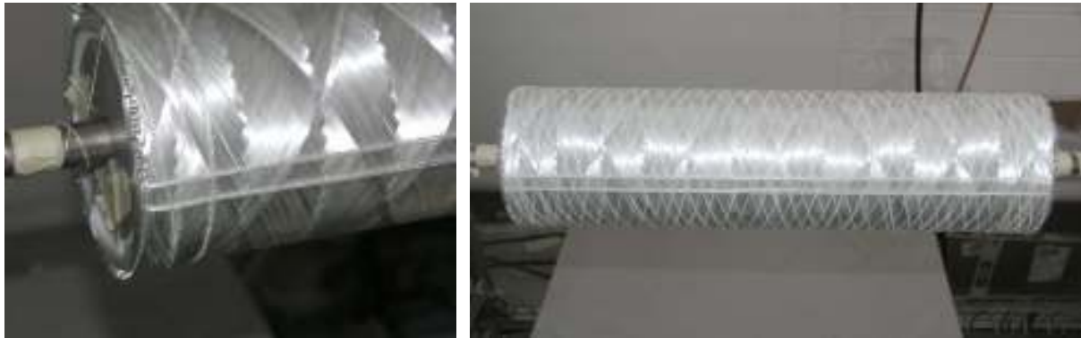
Abbildung 24: Bedeckung mit abgelegten Trägerfäden (axial/radial; Helix)
