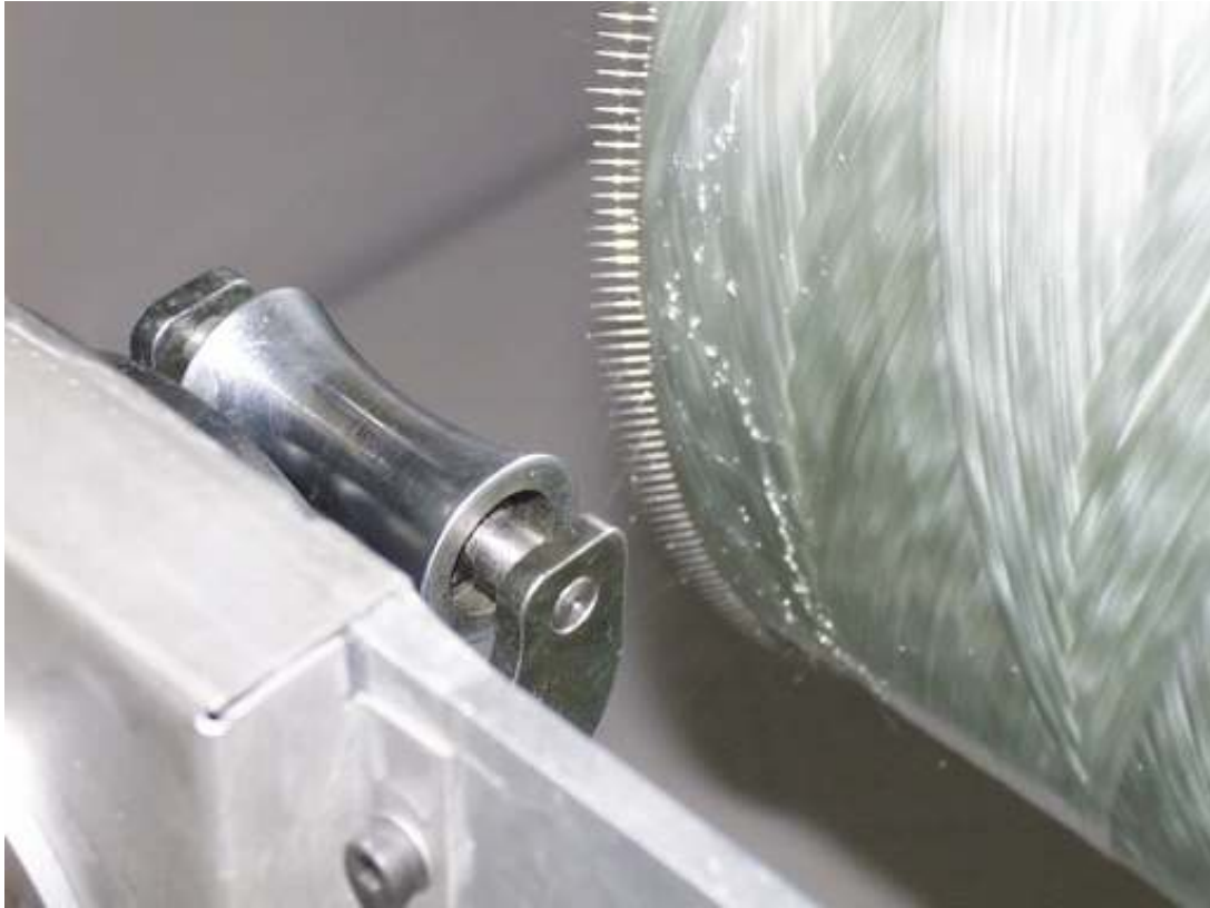
Abbildung 19: Aufgeschmolzener Klebefaden auf einem Gelege
