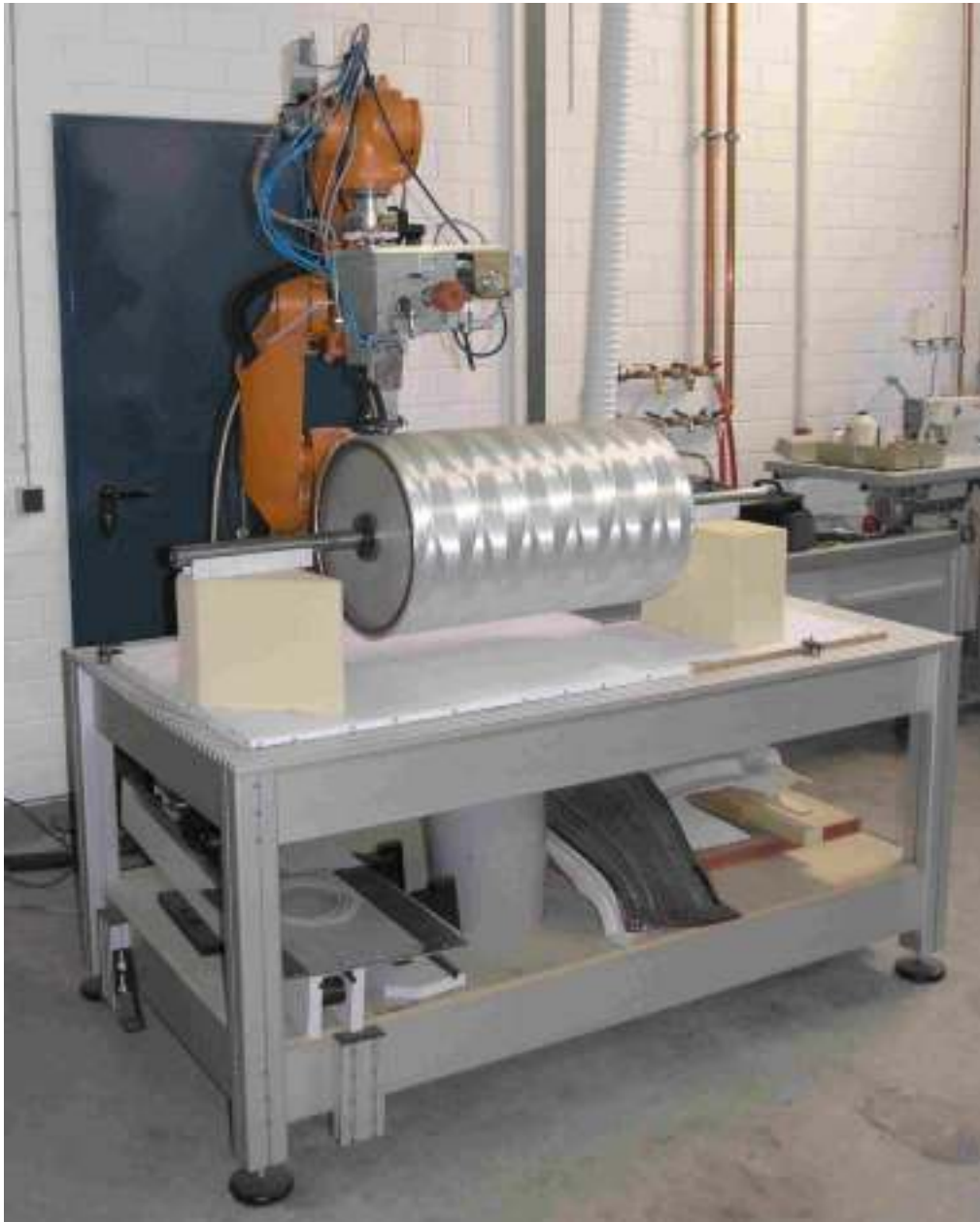
Abbildung 6: Bewickelte Zylinderablage bei Nähversuchen
