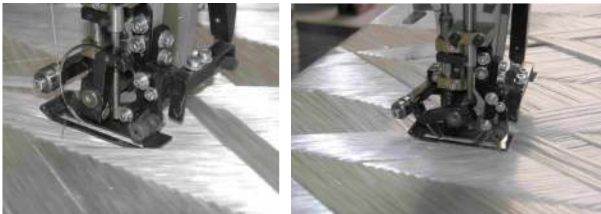
Abbildung 9: Nähversuche Gabelablage; zwischen bzw. auf Kreuzungspunktbereichen
