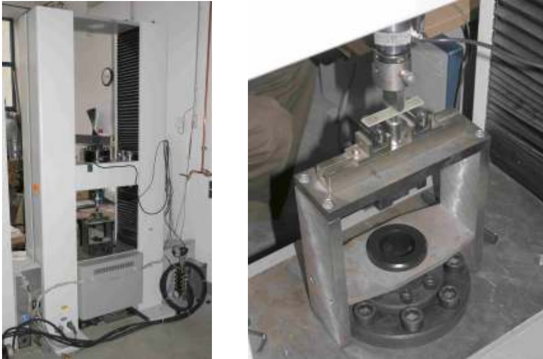
Abbildung 18: Statische Prüfmaschine; Biegebank mit Wickelgelegeprobe
