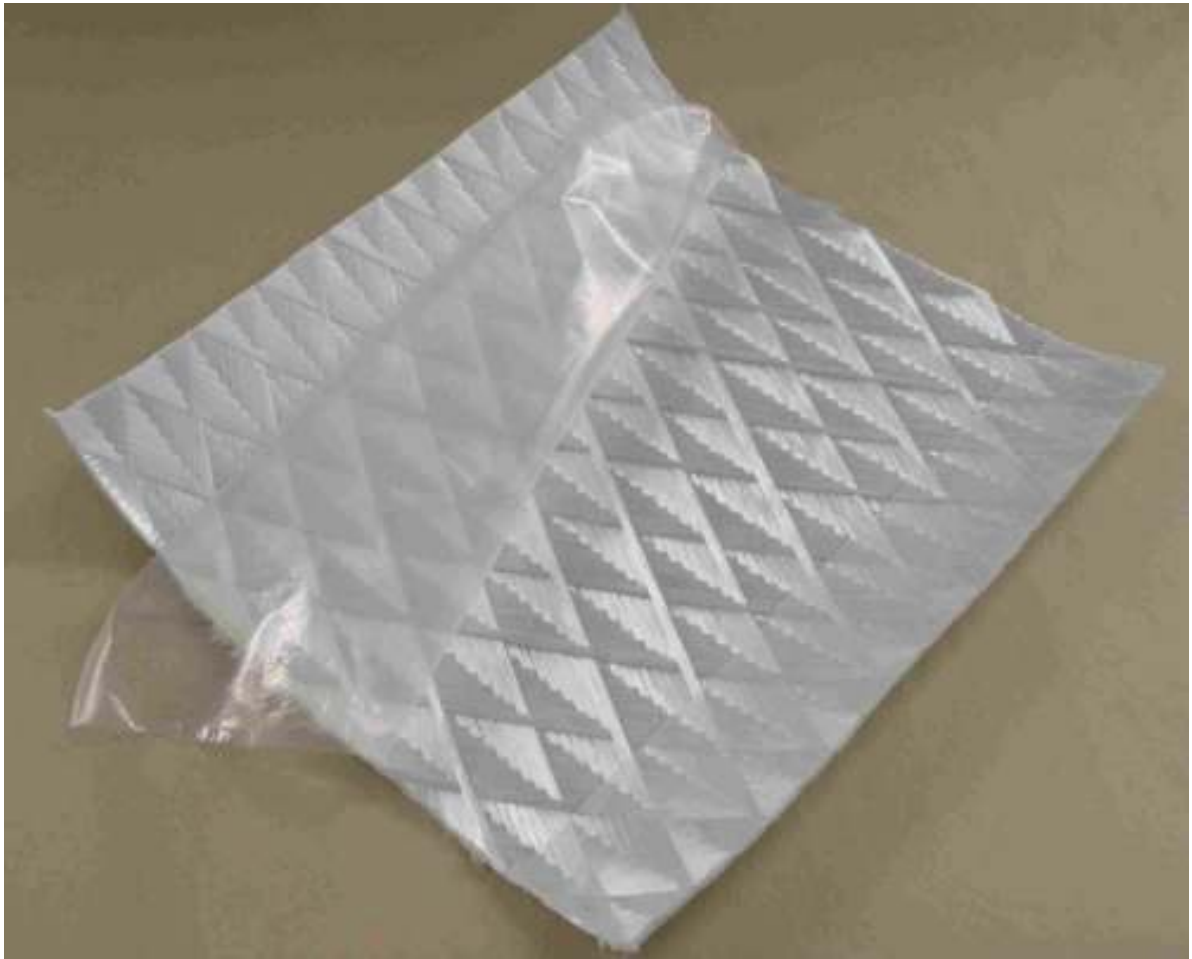
Abbildung 12: Entformtes Gelege beim Entfernen der Trennfolie
