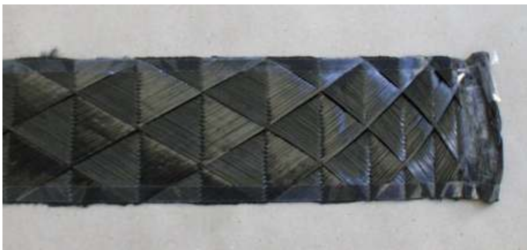
Abbildung 20: Wickelgelege mit kontinuierlich verändertem Faserwinkel
