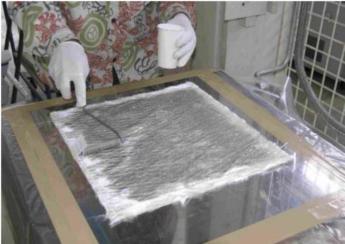
Abbildung 14: Laminieren einer Probeplatte
