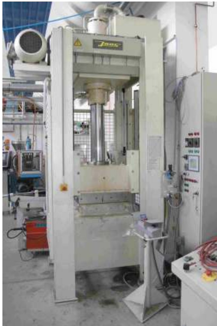
Abbildung 15: Aushärten einer Probplatte unter der Presse
