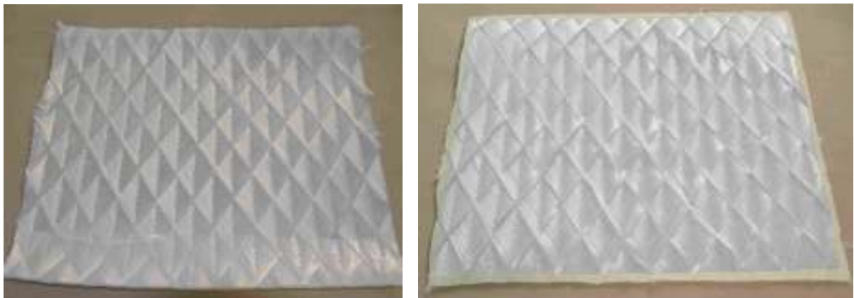
Abbildung 13: Zweiseichtiges GF-Wickelgelege mit Sprühkleberfixierung
