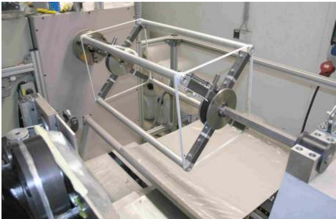
Abbildung 1: Gabelablage mit Wendezonen (Zahnriemenvariante)
